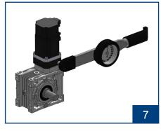
使用扭力扳手將迫緊環螺絲鎖 緊。
