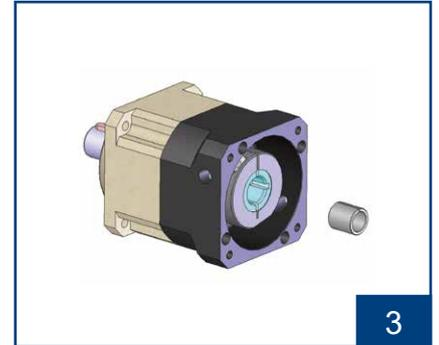
檢查馬達出力軸尺寸，如需軸套，請先裝進入力孔內。
